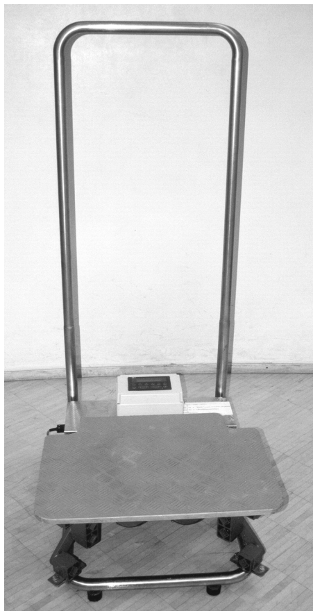
Figure 3. Kuntotäry-platform vibrates vertically (studies II-IV).
